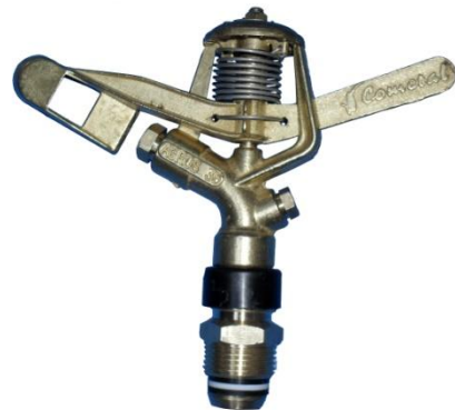
Type Cometal-Agros 35 3/4" aansluiting (uitwendig), met nozzle 4mm of 4.8mm.
